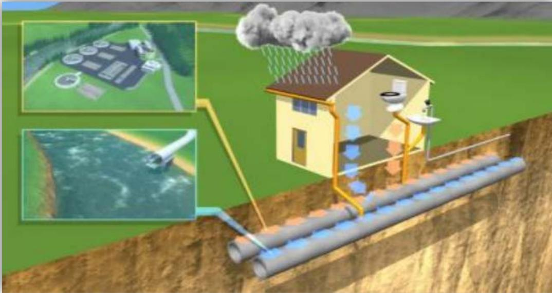
**Figure 4.2.** Représentation schématique d'un réseau séparatif.
