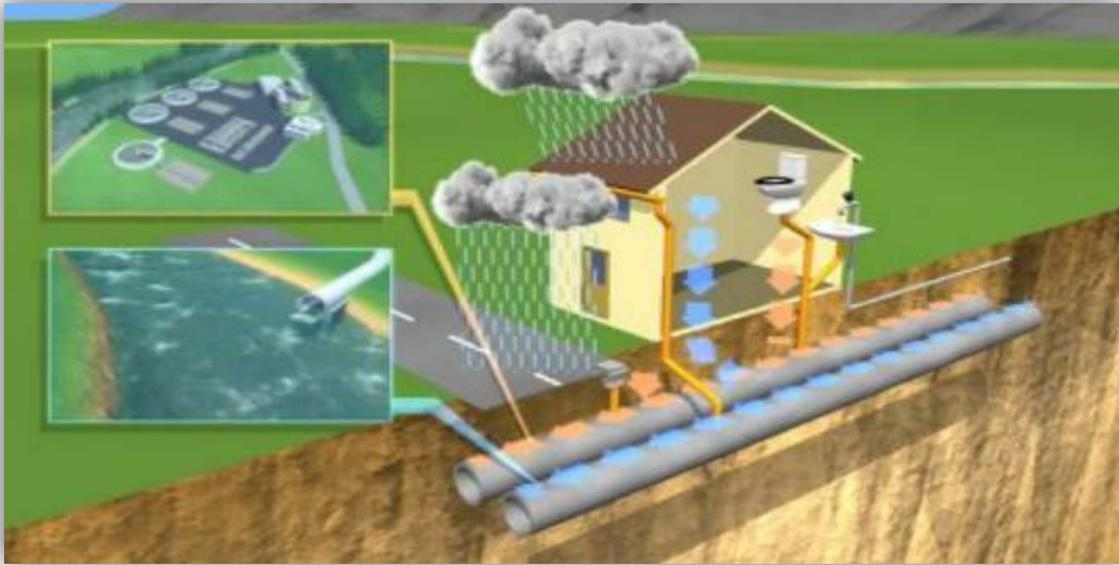
**Figure 4.3.**Représentation schématique d'un réseau pseudo- séparatif.
