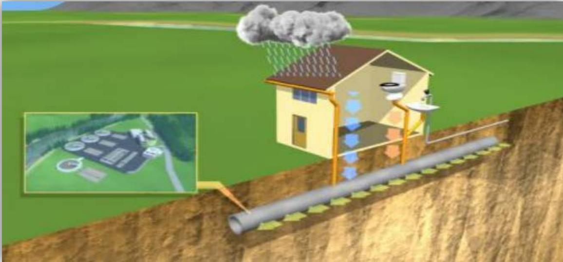
**Figure 4.1.** Représentation schématique d'un réseau unitaire
