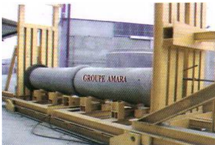
Figure VI.6 Essai de l'étanchéité
