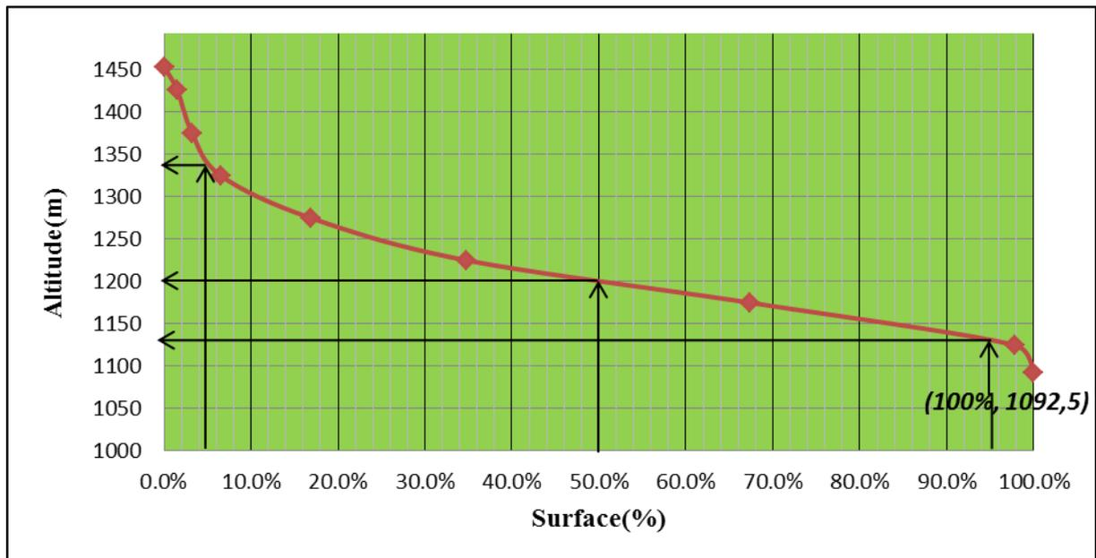
Figure III.2: Courbe hypsométrique
