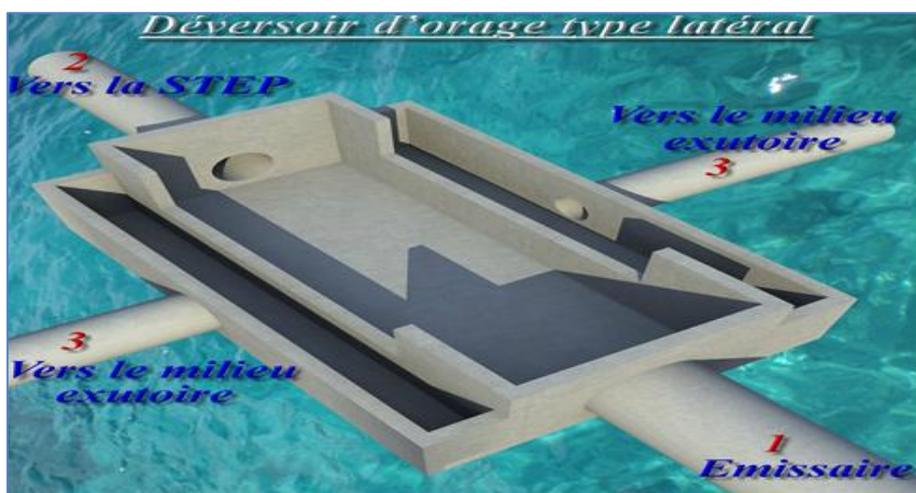
Figure V.3 : Déversoir d'orage type latéral à double seuil
