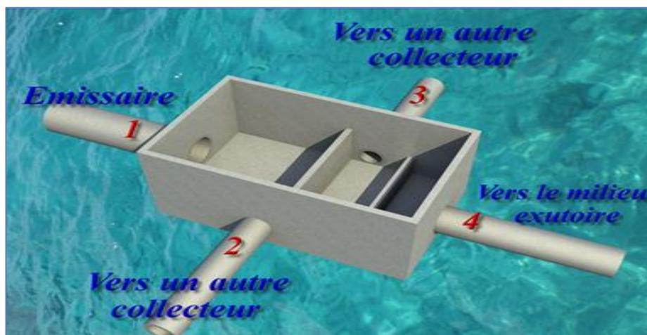
Figure V.5 : Déversoir d'orage type Escalier
