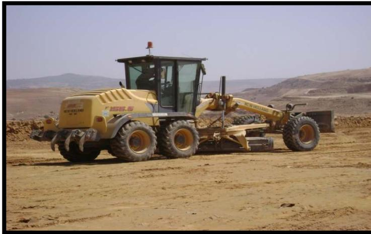
**Figure VII-10: Niveleuse automotrice**
