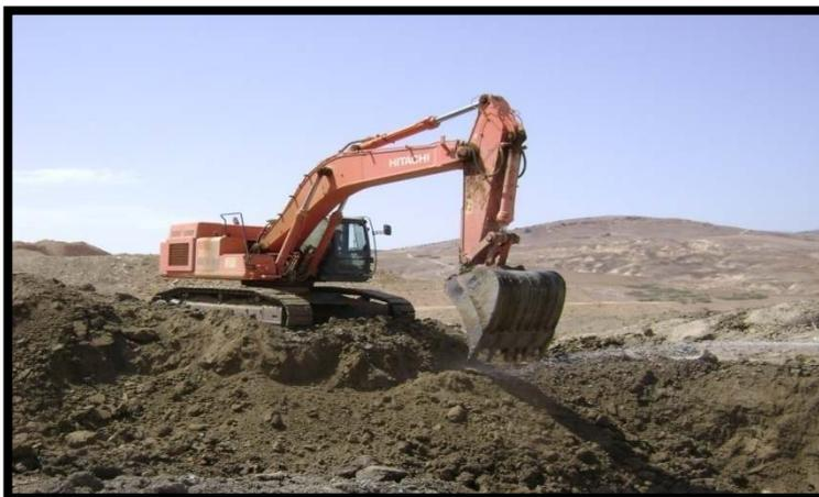
**Figure VII-11: Pelle équipée en rétro**
