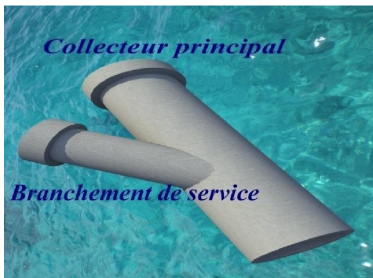
Figure IV4 : Branchement de service. Modélisation en trois dimensions.
