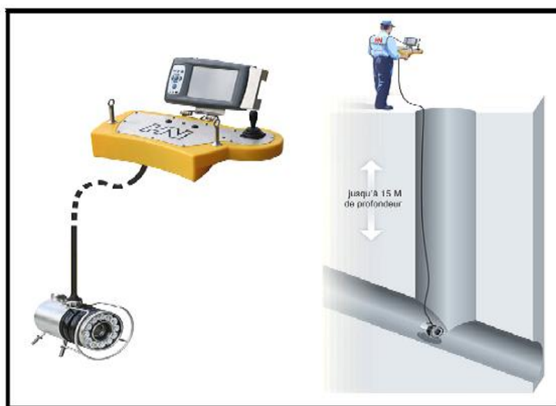
Figure VI-2 : Auscultation au moyen de l'IVP
