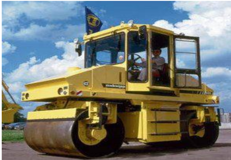
Figure V-10- compacteur à rouleau lisse
