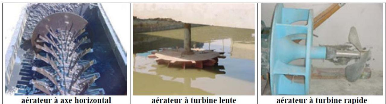
Figure IV.2. Différents types de mobiles d'aération/agitation
