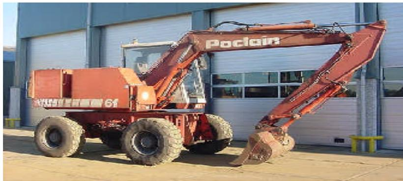
**Figure VI.2: pelle équipée en rétro**
