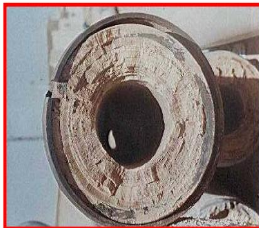
Figure II.1 : Entartrage de la conduite après quatre années d'exploitation dû à la qualité physico-chimique de l'eau et la température élevée.
