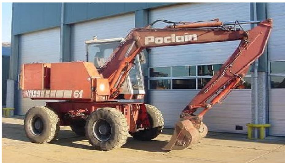
**Figure VII-5: Pelle équipée en rétro**
