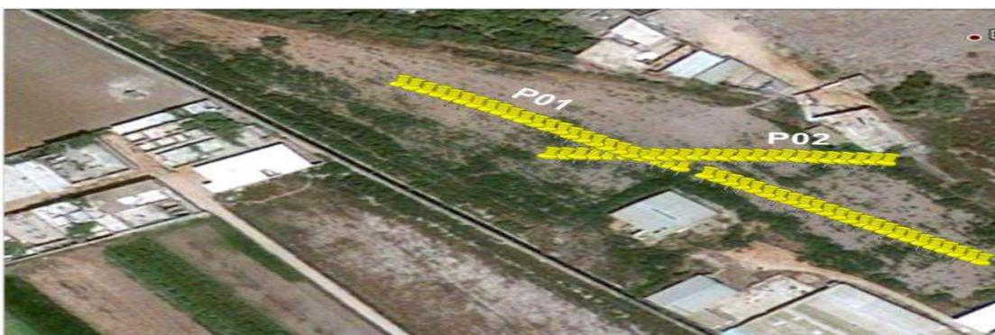
Figure II.04 : Implantation des profils de résistivités électriques.
