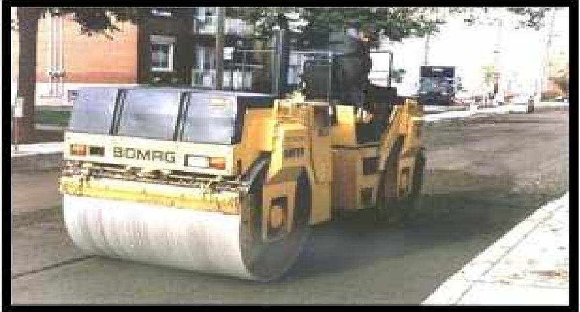
*Figure II.1* photographie d'un rouleau compacteur à cylindre métallique lisse
