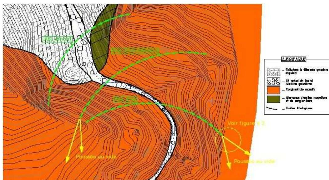
Figure IV-2 : Problématiques du site pour différentes positions d'axe d'un barrage voûte, Source [ANBT], Echelle 1/100 000
