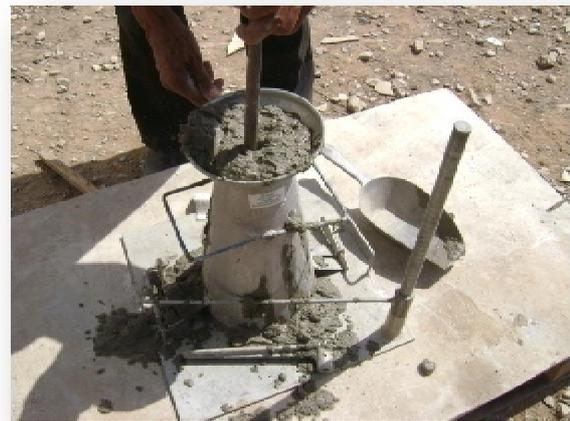
**Essai d'affaissement (cône d'Abrams)**
