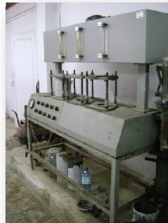
**Essai de perméabilité.**
