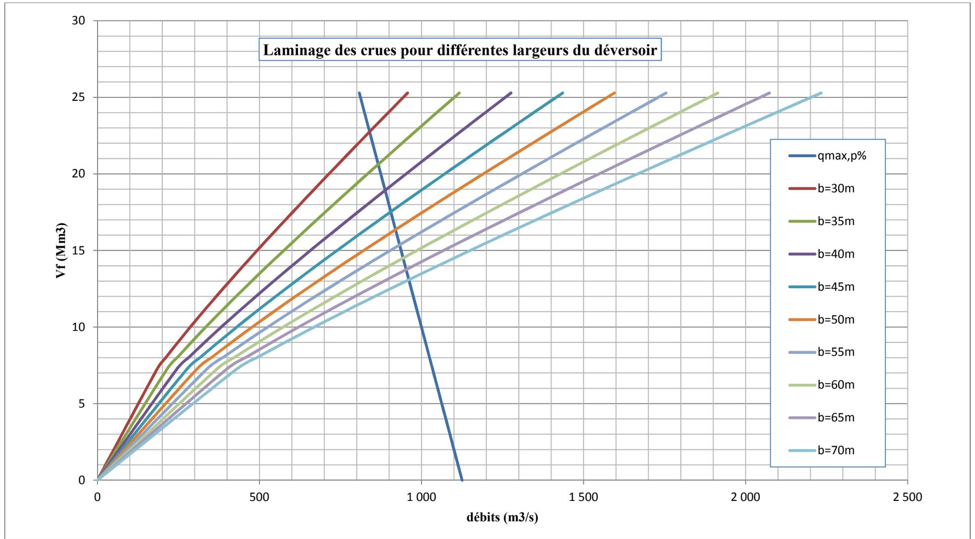
Figure.II.3 : Laminage des crues  $V_f = f(q_{max, p\%})$
