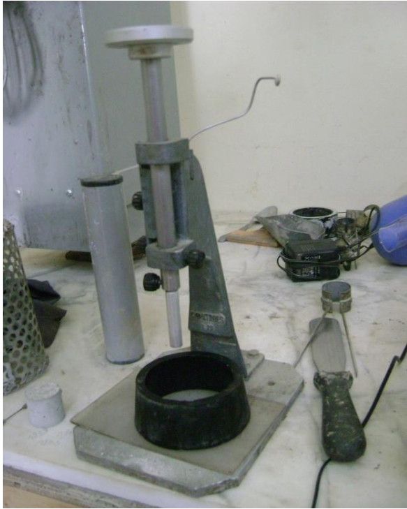
Temps de prise du ciment (appareil Vicat).
