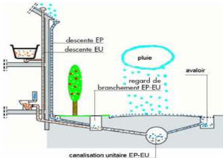
Figure IV.1 : Représentation schématique d'un réseau unitaire.
