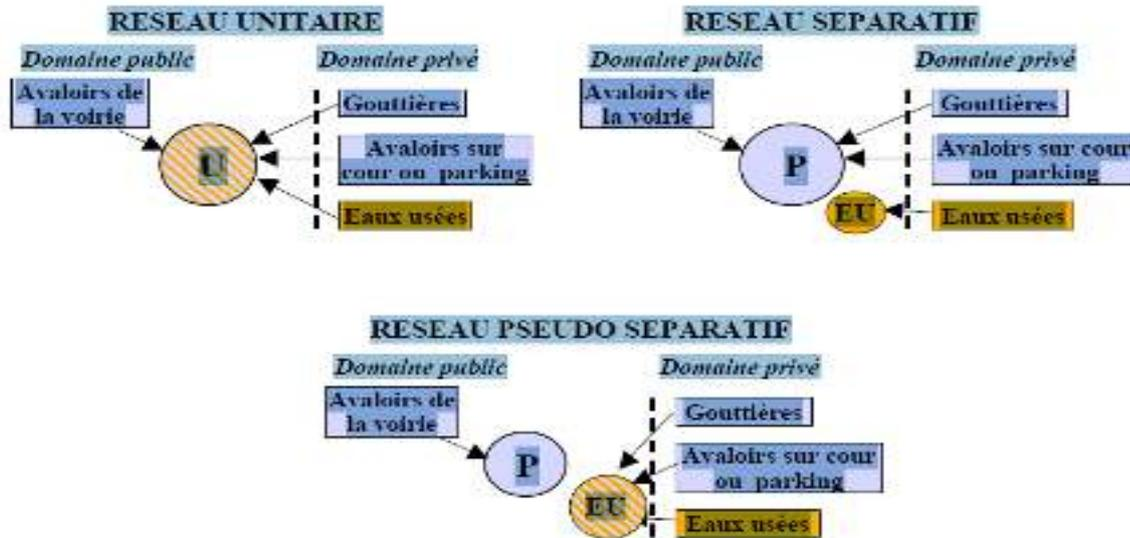
**Figure 4 : Les différents systèmes d'assainissement.**
