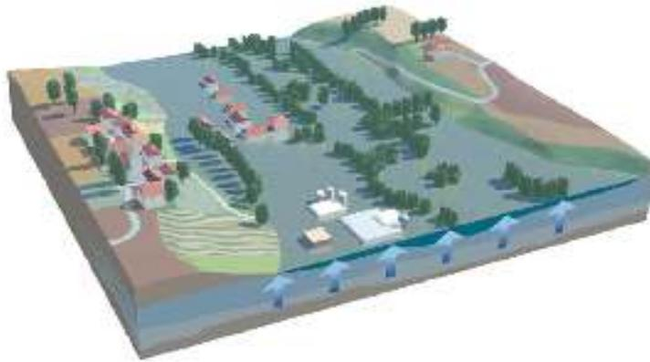
**Figure.I.4.**Inondation par remontée de nappe
