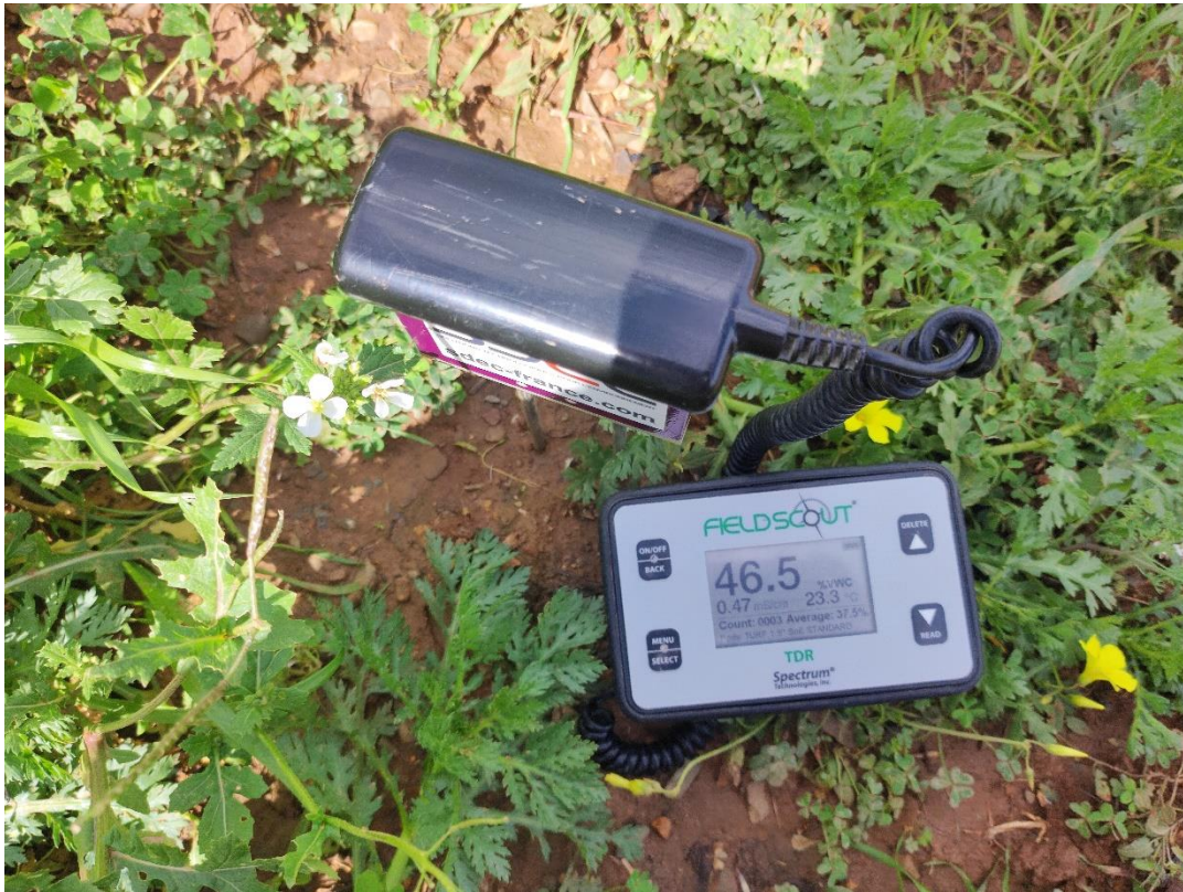
Figure II.02 : Mesure de l'humidité du sol par l'appareil TDR 150 (Mouzaïa : Le 10/03/2024 à 12 :06).
