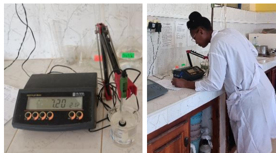
Figure 28. Calibration et lecture du pH à travers le pH-mètre au laboratoire
