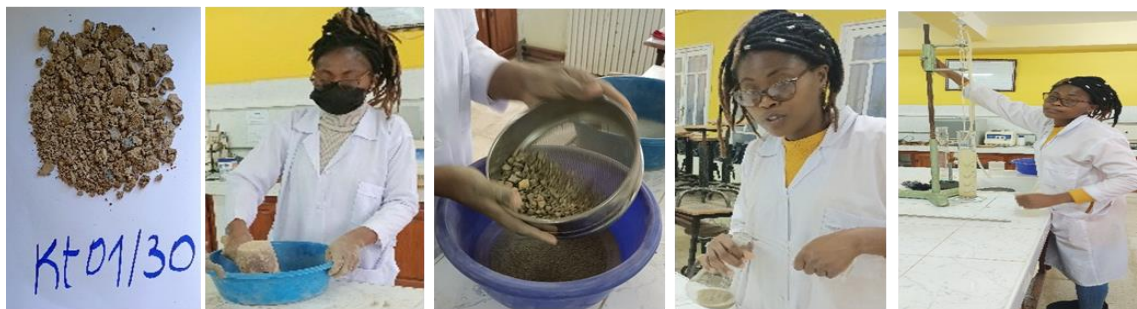
Figure 25. Différentes phases d'analyse granulométrique par sédimentométrie
