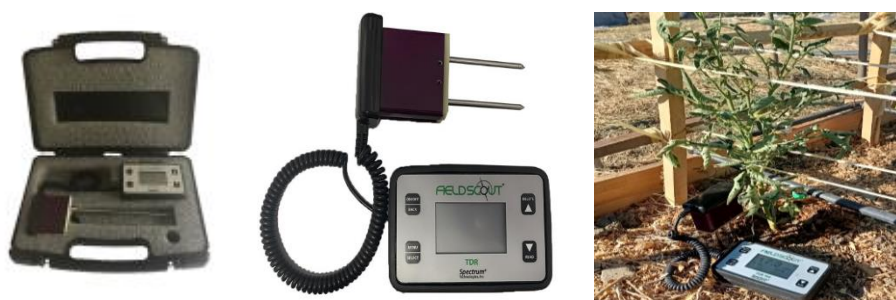
Figure 20. Présentation et mesure de l'état du sol avec le TDR 150 aux pieds des tomates
