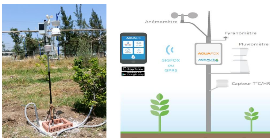
Figure 18. Station météorologique automatisée installée in – situ (à gauche), avec à droite, ses différents paramètres climatiques présentés et leurs lectures sur le site Aqualis
