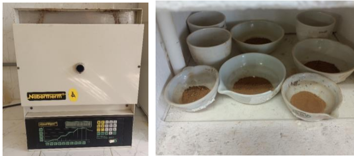
Figure 27. Four à moufles et échantillons disposés à l'intérieur pour l'analyse par perte au feu
