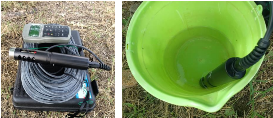
Figure 34. Analyse de l'eau via la sonde multiparamètre HI990
