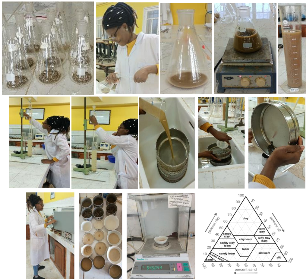
Figure 26. Mode opératoire de l'analyse granulométrique par sédimentométrie permettant de déterminer les différents pourcentages de sables, argiles et limons
