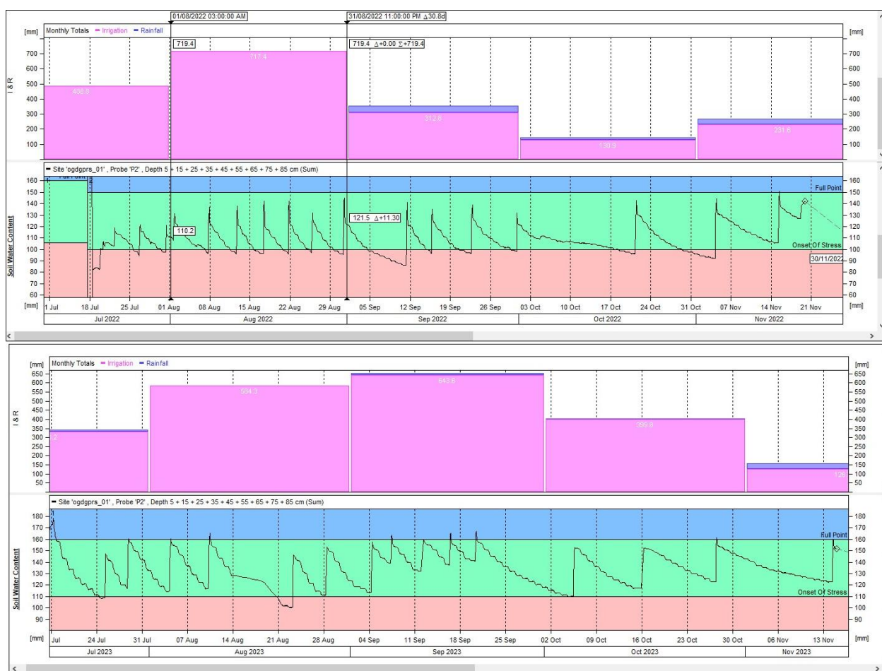
Figure 132. Comparaison de l'humidité du sol le long d'un profil de 85cm de profondeur de la sonde 1 suite aux apports d'eau par mois pendant deux campagnes (2022, 2023)
