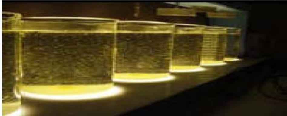
*Figure I.4 : Essai de coagulation dans une usine de traitement.*
