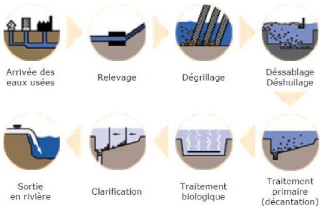
*Figure I.1 : Illustre les différentes étapes et procédés de traitement des eaux usées*
