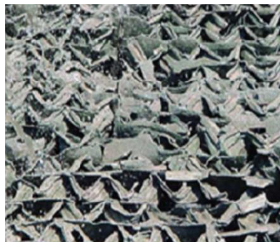
Figure III.15 : éléments de remplissage du lit bactérien
