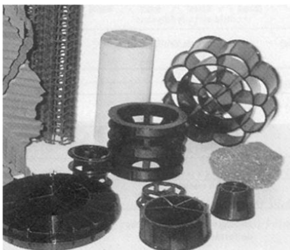
Figure III.14 : Pièces ou matériaux à l'intérieur du lit
