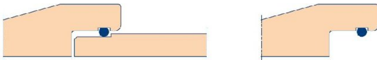
Figure VII.8. Assemblage par Bague glissante à appliquer dans une encoche du collet.
