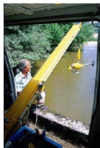
Figure II.9: Jaugeage de crue au saumon. ( Mussy, 2002)
