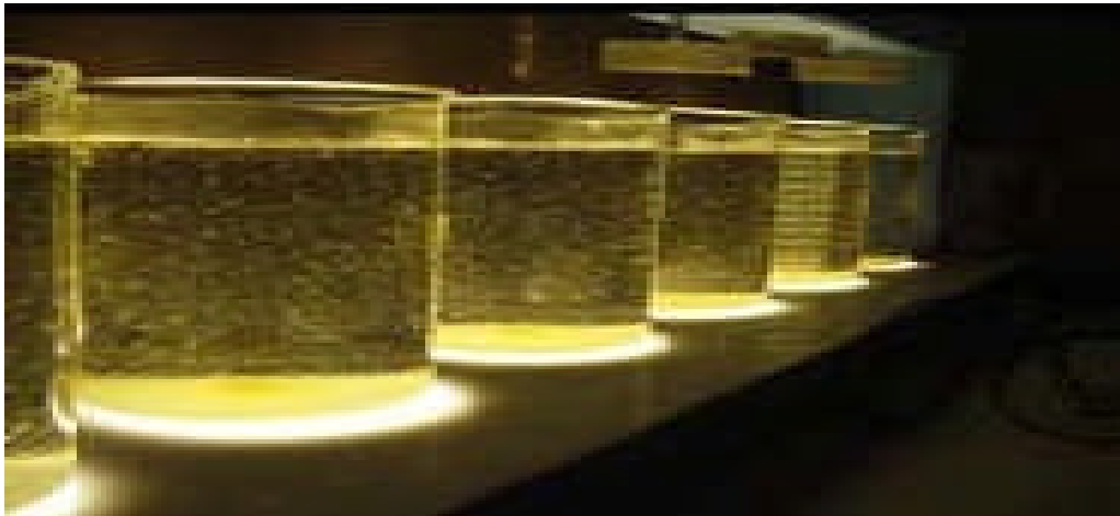
Figure III.7 : Essai de coagulation dans une usine de traitement.
