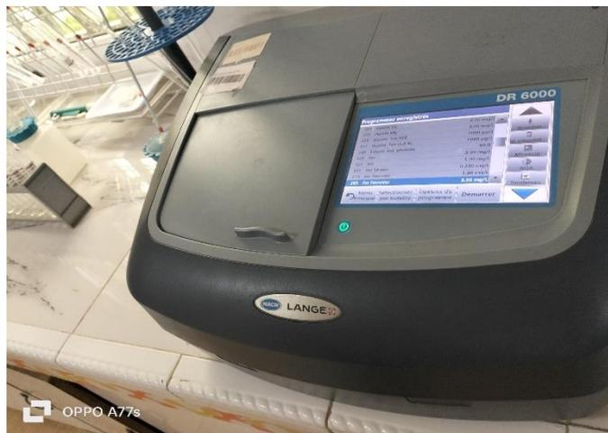
Figure V.11: spectrophotomètre (DR 6000).
