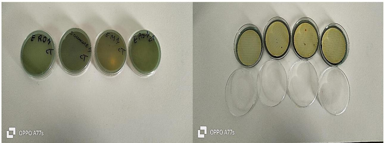
Figure V.17: filtres des coliformes totaux
