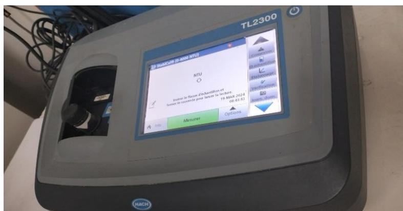
Figure V.5: Turbidimètre (TL2300). (17/3/2024)
