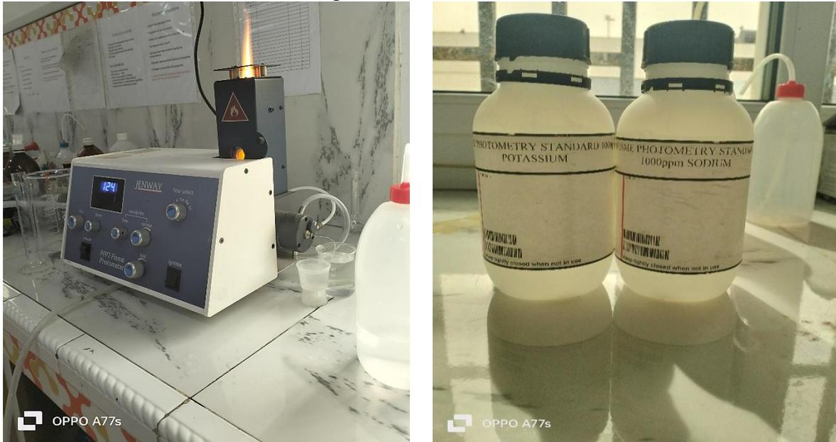
Figure V.10 : Photométrie de la flamme (PFP7 – Jenway) et les étalons
