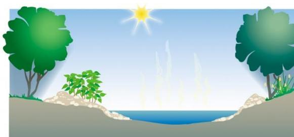
Cours d'eau curé : élargissement du lit d'étiage, réduction de l'ombrage, réchauffement de l'eau. Développement d'espèces invasives, type renouée du Japon, sur les matériaux de curage.
