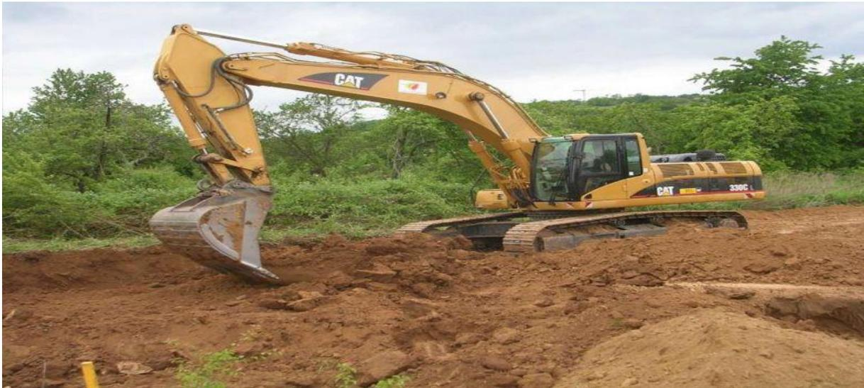
Figure VII.1 : Pelle à chenilles avec godet à position rétro.
