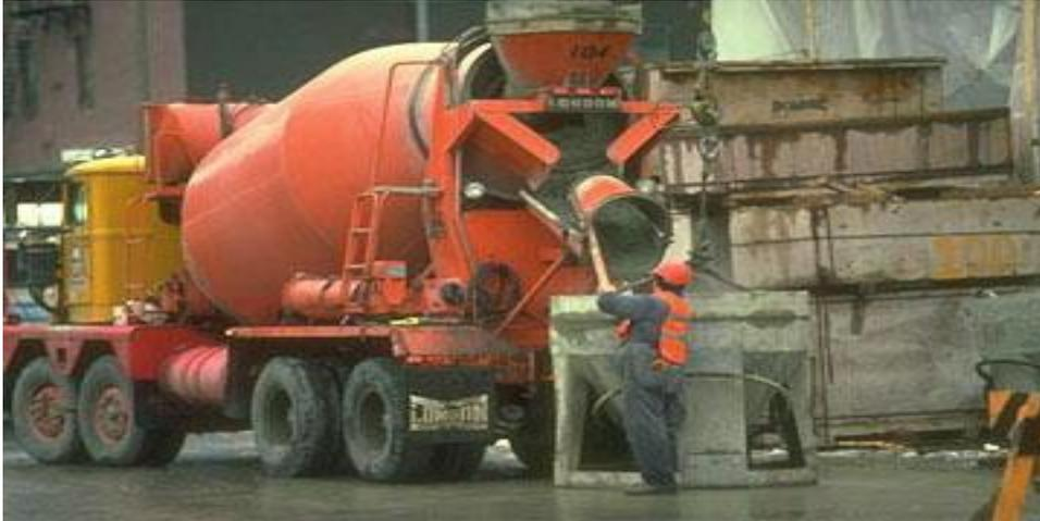
Figure VII.5 : bétonneuse.
