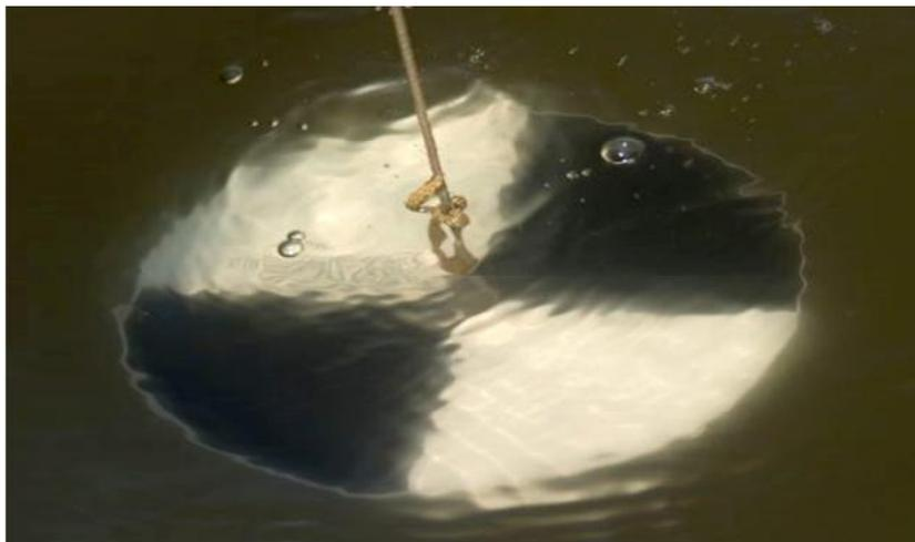
Figure VI.1 : disque de Secchi. (Source : aquameric.com)
