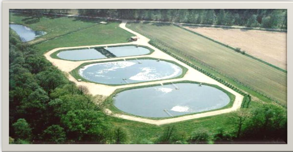
Figure III.6: système d'épuration par lagunes aérés
