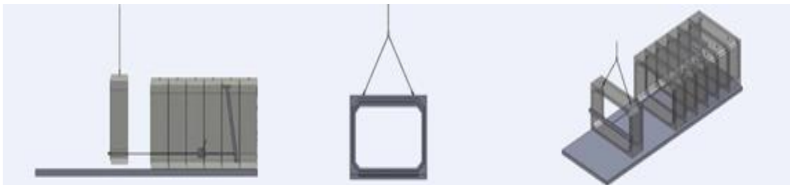
Figure VIII.3. Pose dalot avec ancre de levage-
