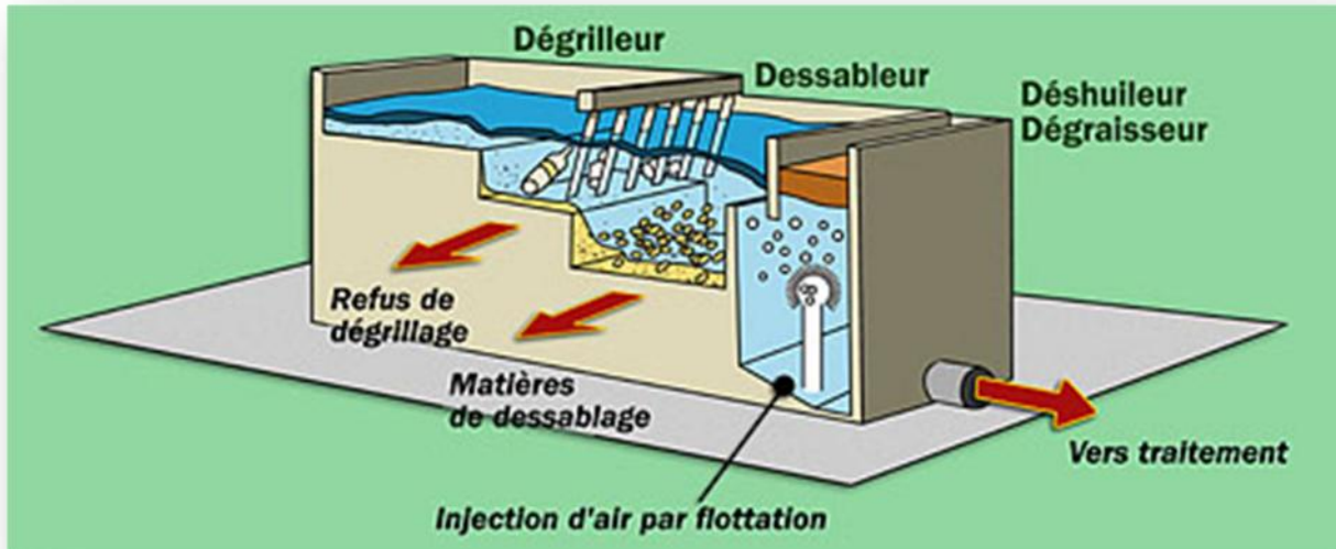
Figure VI.6 : Schéma type d'une filière de prétraitements.
