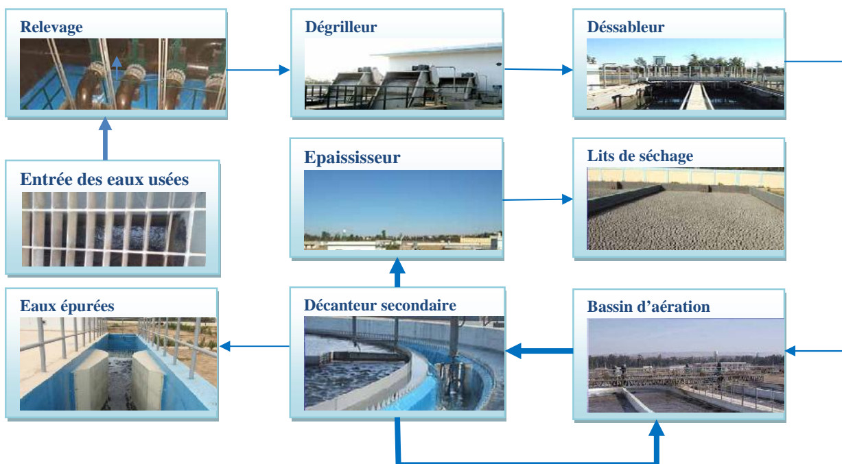
Figure IV.1 : Schéma général d'une station d'épuration de la ville de CHLEF.
