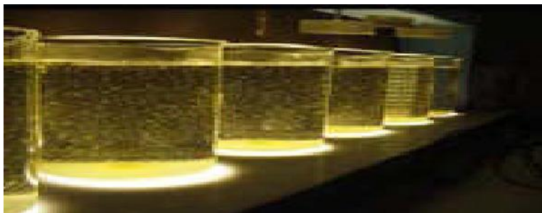
Figure IV .8 : Essai de coagulation dans une usine de traitement.(site web)
