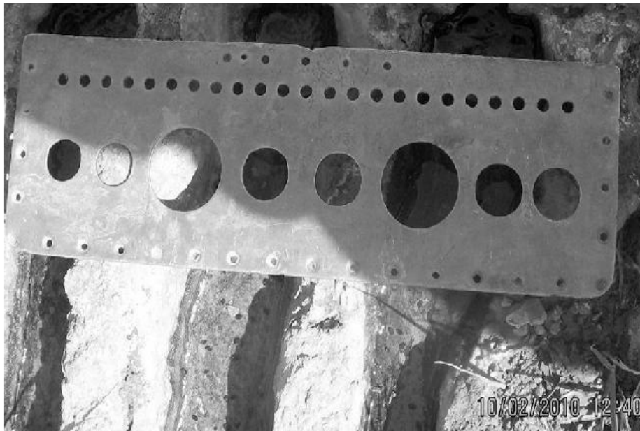
Figure 1.11: Une plaque de jaugeage (Louh) utilisée dans l'oasis de Timimoun (Remini,2010).
