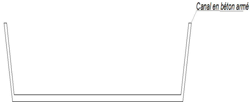
Figure IV-30 Canal trapézoïdal en béton armé
