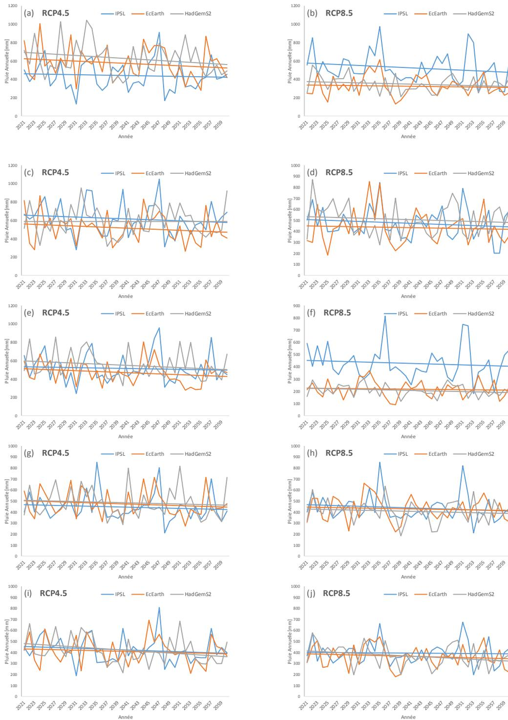
**Figure IV. 8** | Evolution des précipitations futures des barrages : (a) : SMTB scénario RCP4.5 ; (b) : SMTB scénario RCP 8.5 ; (c) : Harreza scénario RCP 4.5 ; (d) : Harreza scénario RCP 8.5 ; (e) : Gargar scénario RCP 4.5 ; (f) : Gargar scénario RCP 8.5 ; (g) : Bakhadda scénario RCP 4.5 ; (h) : Bakhadda scénario RCP 8.5 ; (i) : SMBA scénario RCP 4.5 ; (j) : SMBA scénario RCP 8.5.
