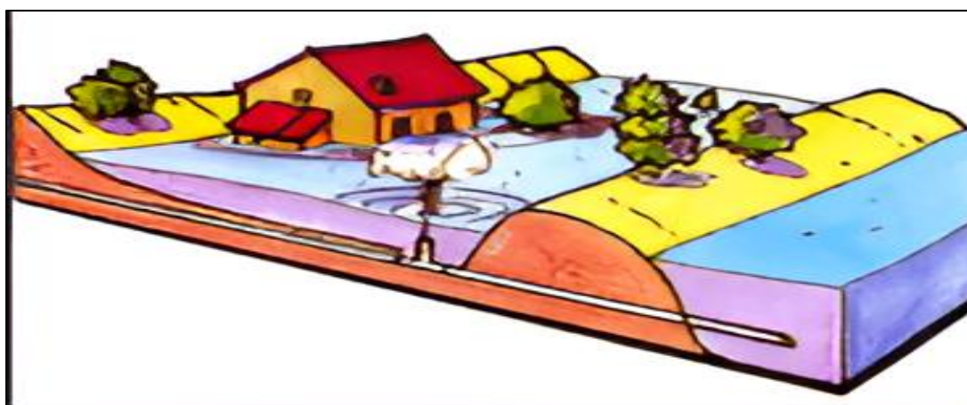
Figure I.4 Inondation par remontées des nappes phréatiques.
