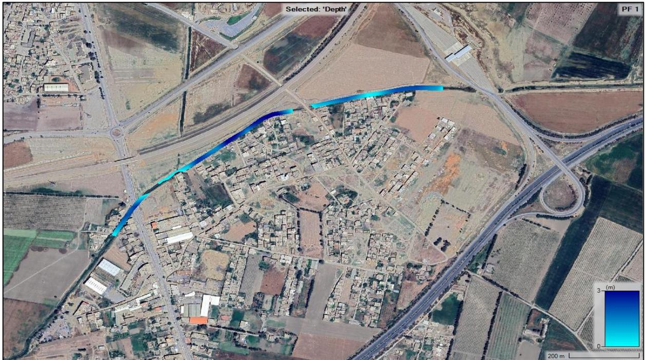
**Figure V.12** : Carte de la profondeur d'eau de l'oued Melah après aménagement pour une période de retour de 100 ans avec un canal trapézoïdal en béton armé.
