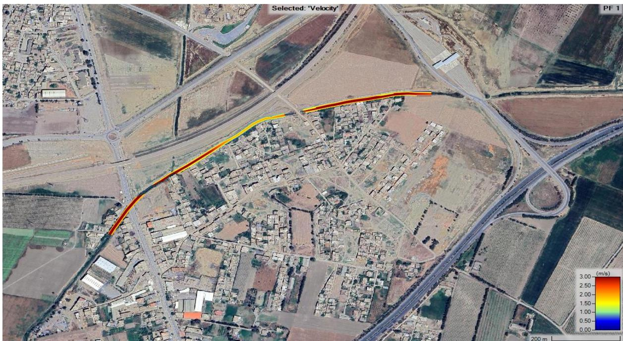
**Figure V.13** : Carte de vitesse oued Melah après aménagement pour une période de retour de 100 ans avec un canal trapézoïdal en béton armé .
