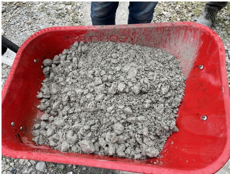
**Figure VI.1** : mélange granulaire d'une formation de béton BCR réalisé par l'étudiante
