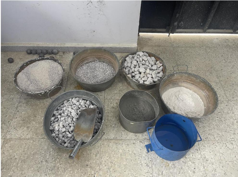
**Figure VI.2** : les différents composants du béton BCR
