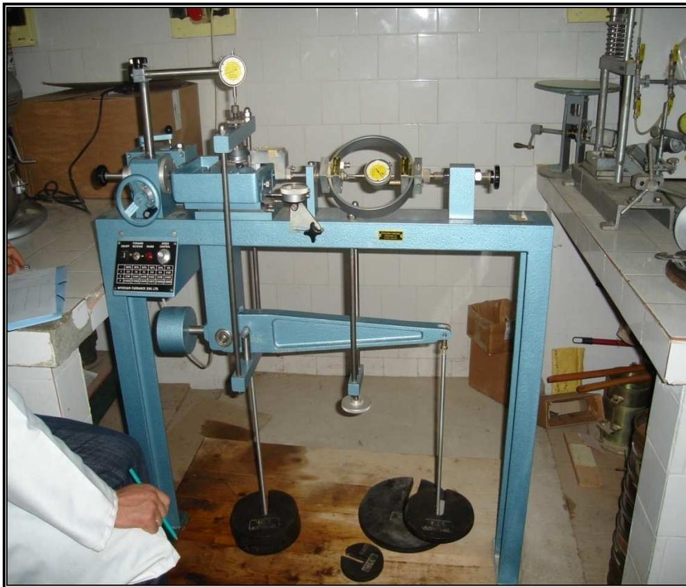
**Figure II.11:** Appareil de cisaillement direct.
