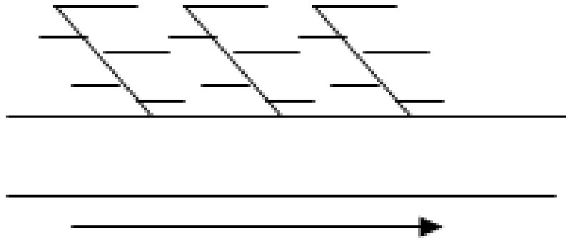
Figure IV.7 : Schéma à Collecteur Etagé
