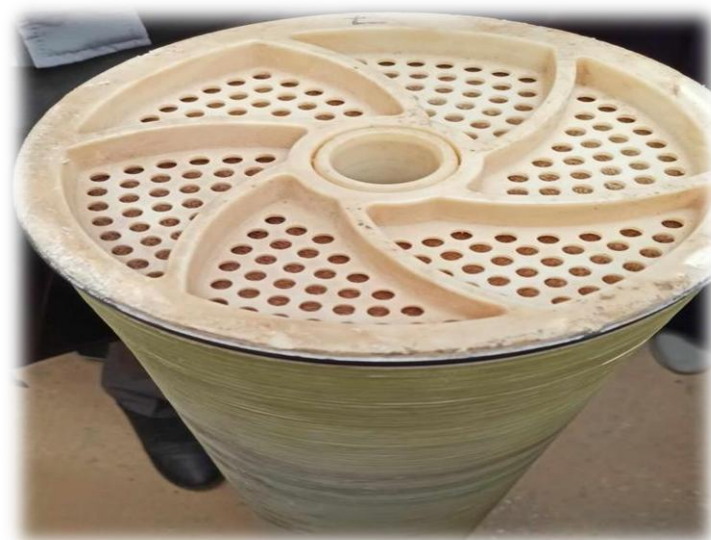
Figure IV.6. Le module d'osmose inverse.
