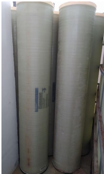
Figure III-6 : modules d'osmose inverse.
