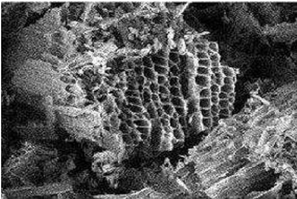
Figure VII.8 : Structure microscopique du charbon actif
