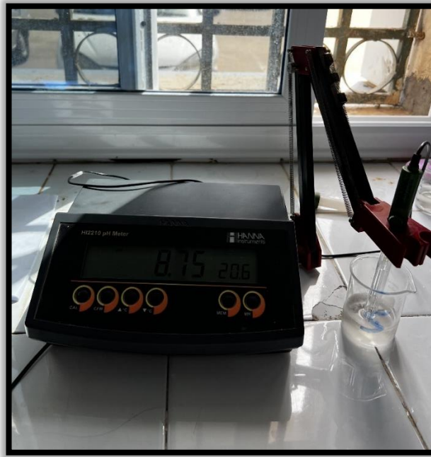
Figure IV.2: Mesure du PH (Photo prise au laboratoire de l'ENSH)
