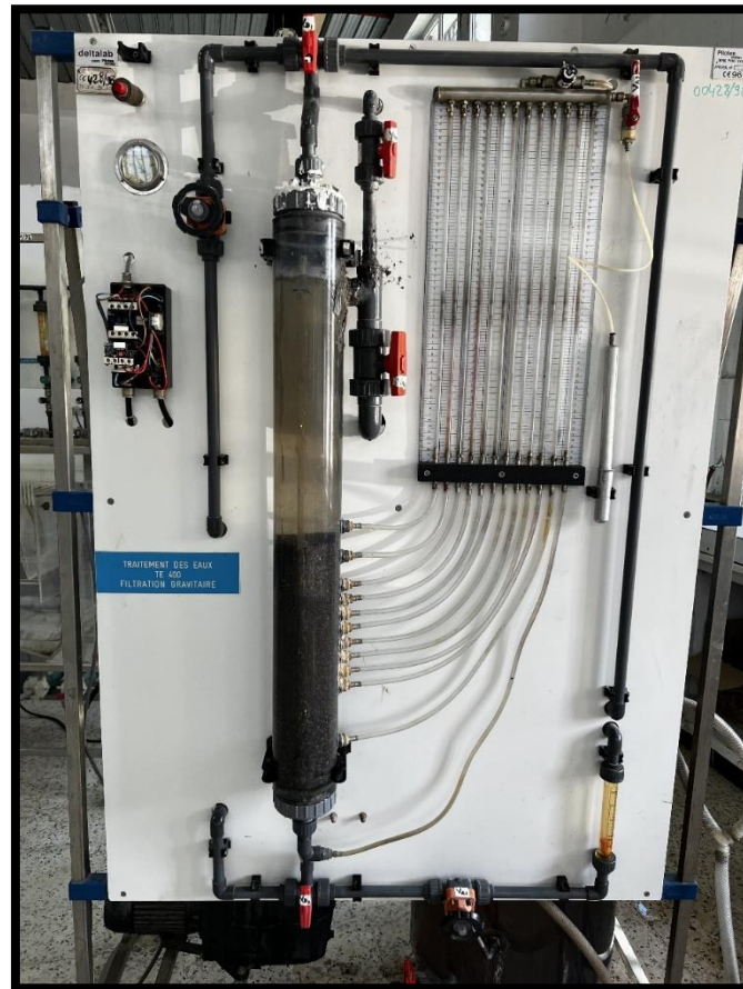
Figure IV.1: Pilote de filtration gravitaire sur sable (Photo prise au laboratoire de l'ENSH)
