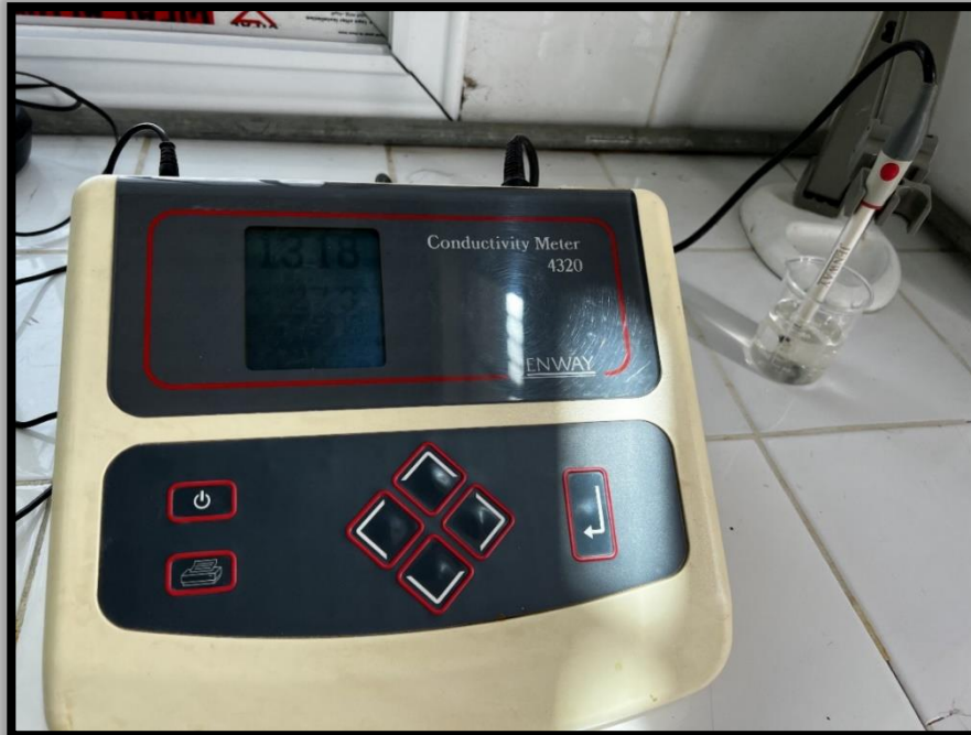
Figure IV.3: Mesure de la conductivité (Photo prise au laboratoire de l'ENSH)
