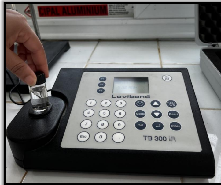
FigureIV.4: Mesure de la turbidité (Photo prise au laboratoire de l'ENSH)
