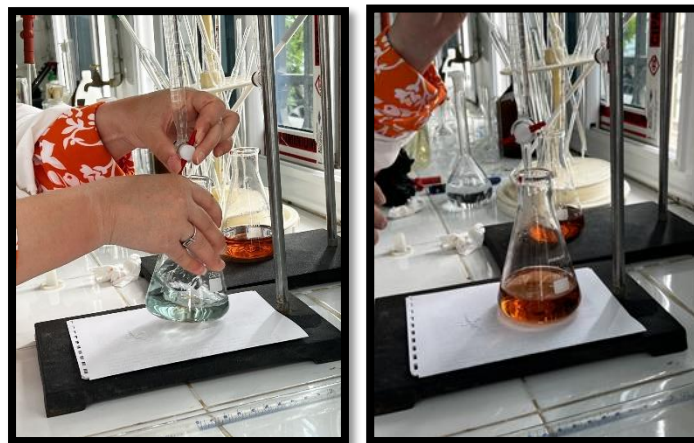
FigureIV.11:Titrage par sulfate de fer et d'ammonium (Photo prise au laboratoire de l'ENSH)
