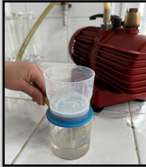
FigureIV.5: Rampe jetable + Pompe à vide (Photo prise au laboratoire de l'ENSH)
