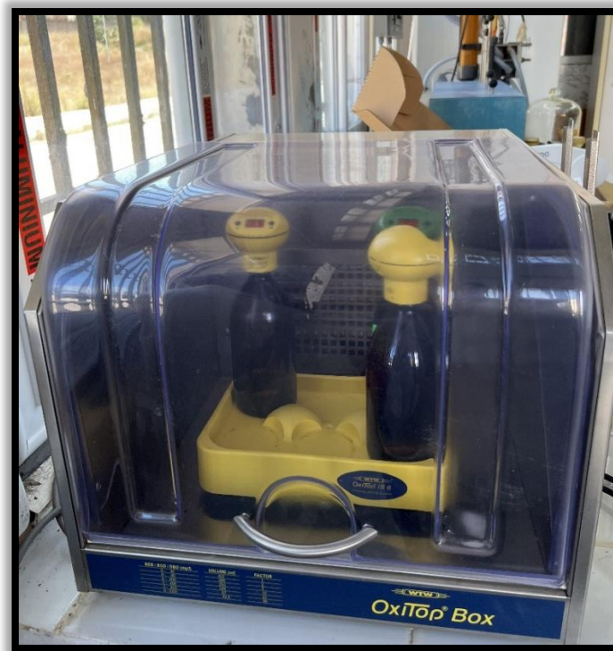
Figure IV.9: Dispositif de mesure de la DBO5 (Photo prise au laboratoire de l'ENSH)
