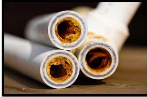
*figure III .1. Conséquence d'une eau agressive sur les conduites*
