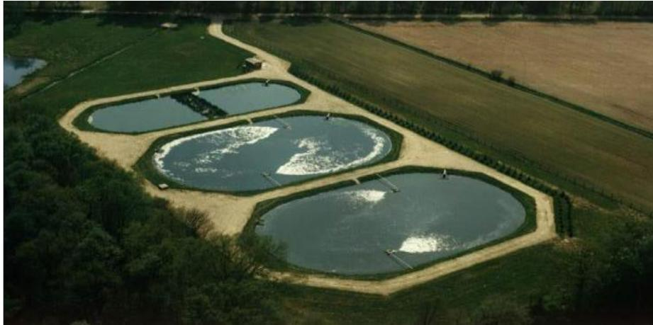
Figure I-6: Système d'épuration par lagunes aérées.
