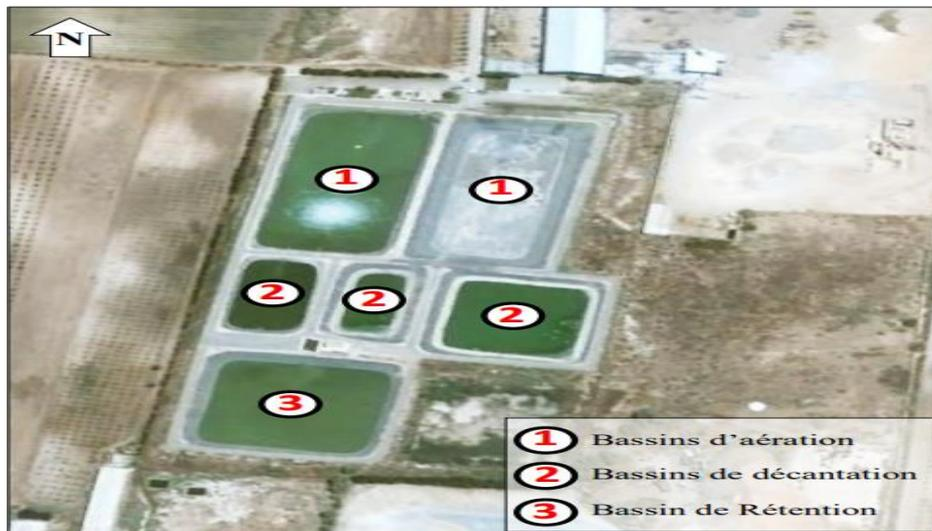
**Figure III.2 :** Synoptique de la Station de Lagunage de Beni Yah.
