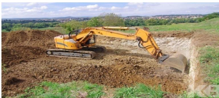
**Figure VIII.2:** Pelle hydraulique.
