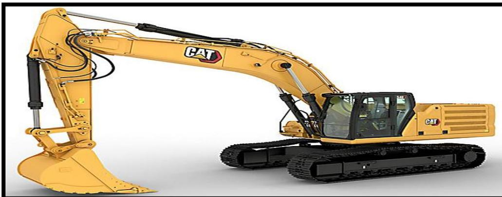
FigureVII.2 : Pelle hydraulique équipée de retro.
