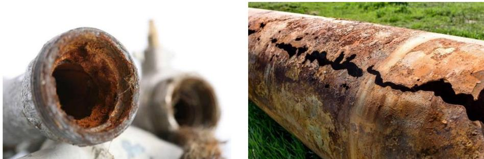
**Figure VI-3 :** Effets de la corrosion sur les conduites métalliques
