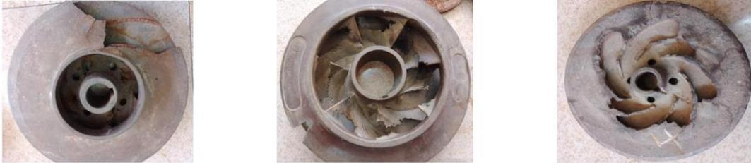
Figure V-12 : Corrosion et érosion de roues de pompes centrifuges par cavitation [9]
