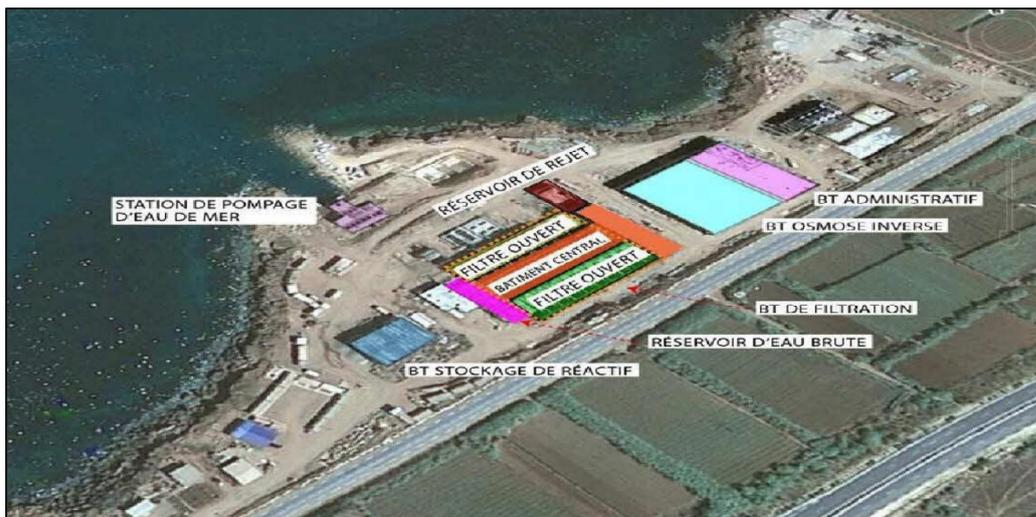
**Figure I-6 :** Schéma des différentes installations dans la station de dessalement FOUKA 2 en cours de réalisation (source : CTH)
