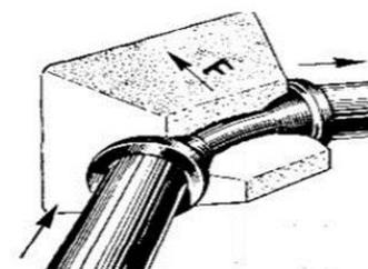
Figure VI-12 : Conduite munie d'un coude [11]
