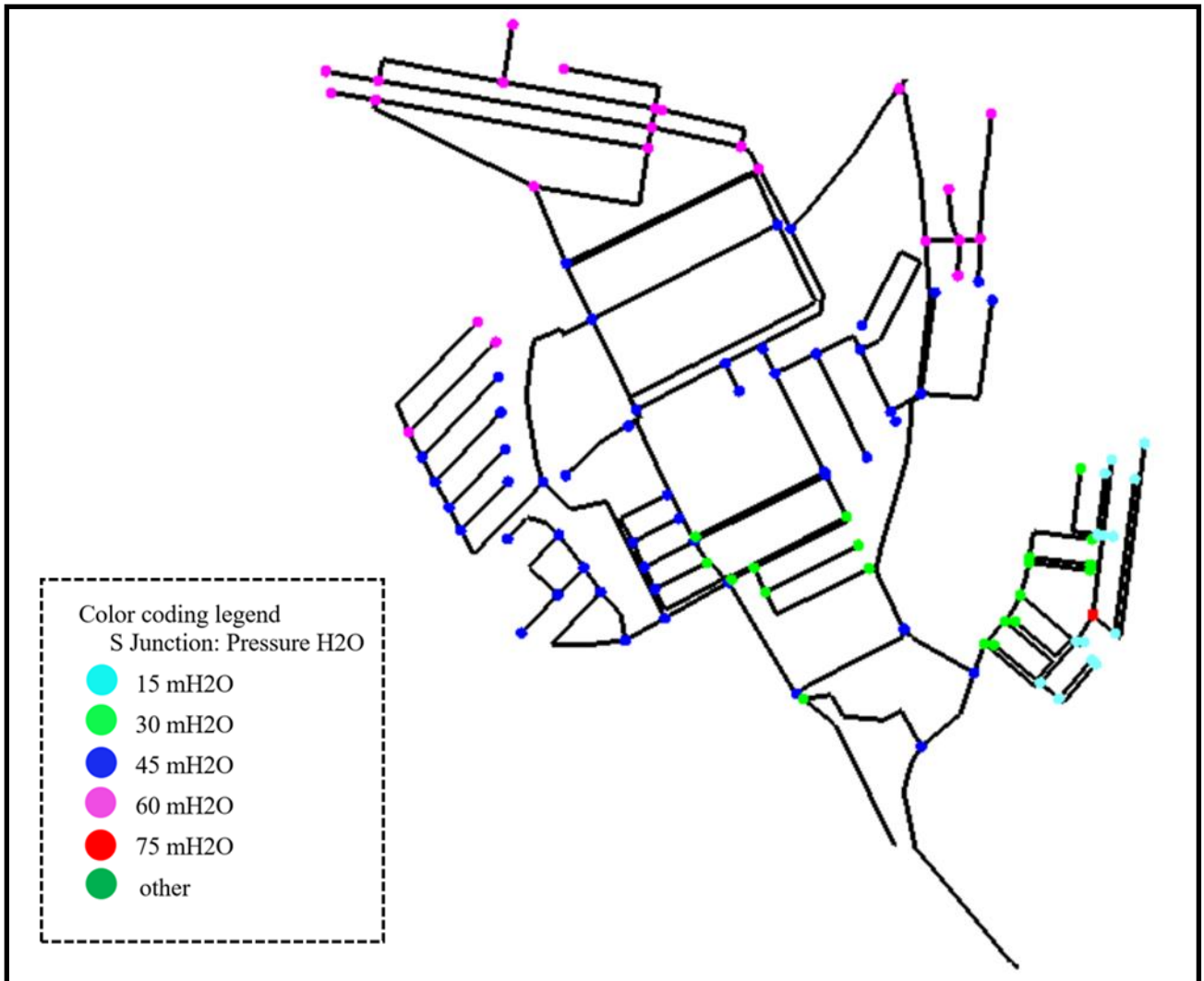
Figure 2.12 : Simulation en cas de pointe + incendie pression
