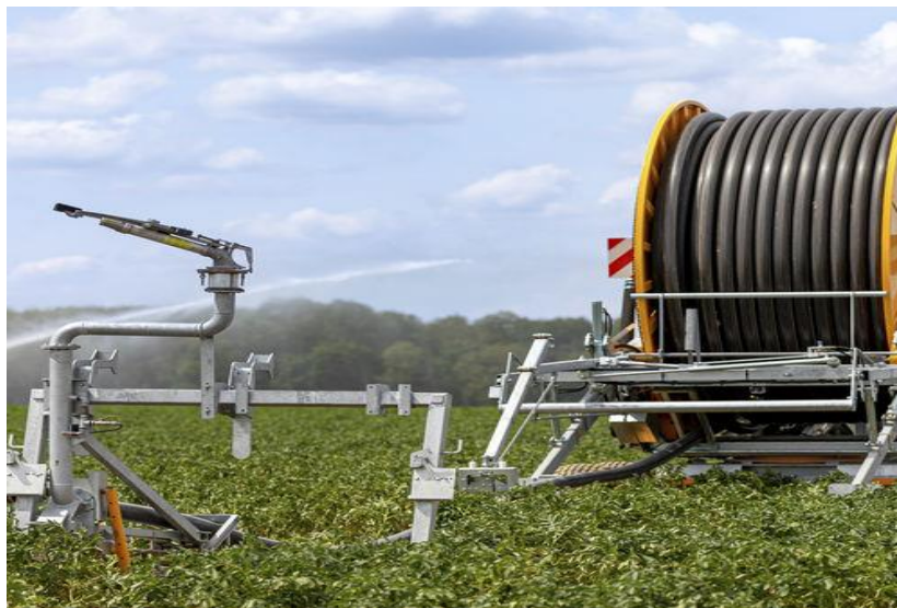
FigureVI .2 : Système d'irrigation par enrouleur [20]
